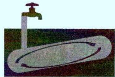
※耐震性貯水槽
